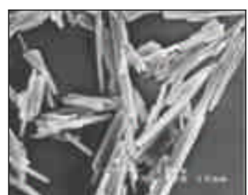
Palčkam podobni delci izhodnega loratadina. Slika je narejena z vrstičnim elektronskim mikroskopom – SEM.
